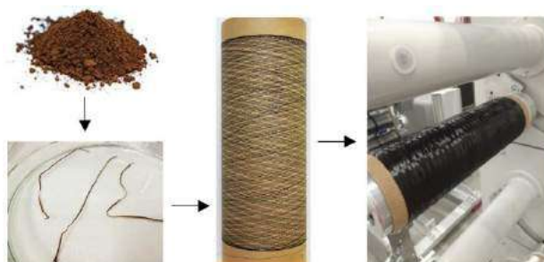
Figure 1: De la matière première jusqu'à la fibre de carbone
