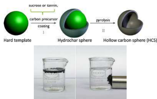
Figure 1 : Principe de la préparation d'une sphère de carbone creuse, et comportement à la surface de l'eau (et récupération magnétique éventuelle).
