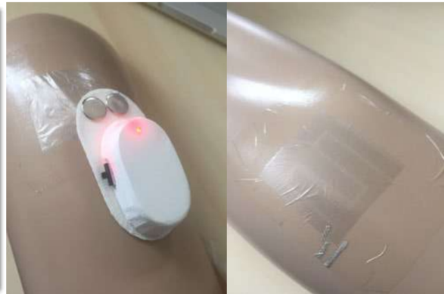
Figure 2 : Pansement intelligent à base de film de graphène sur polymère
